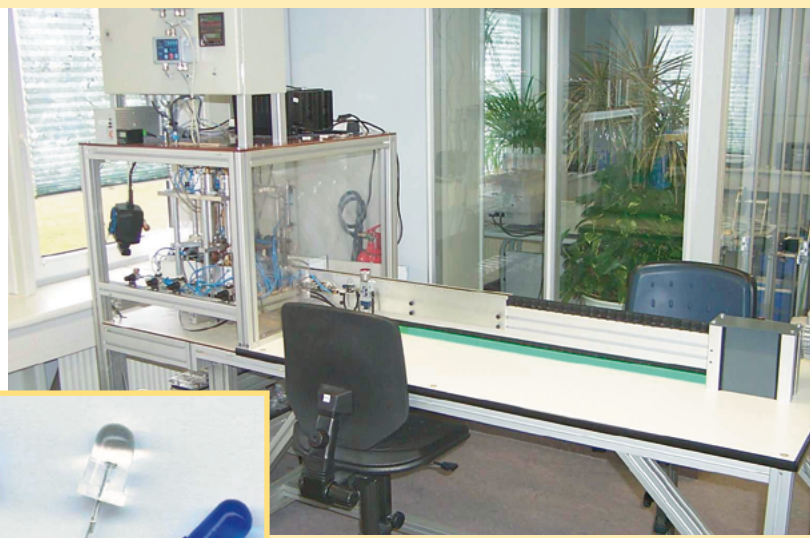
Vollautomatischer LED-Bestückungsautomat Full automatic LED-selection-machine
