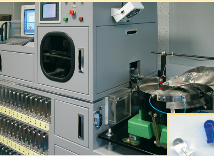
Vollautomatischer LED-Selektionsautomat Automatic LED-selection-machine
