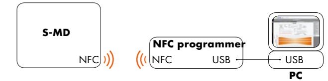
Рисунок 50: Программирование блока питания через NFC
